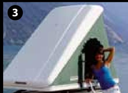
Die Columbus Serie ist mit einer sich selbst öffnenden Gasfeder-Automatik ausgestattet. Nach Öffnen des hinteren Verschlusses wird die obere Dachschale durch die beiden Gasfedern aufrichtet und der Zeltstoff straff gespannt.
