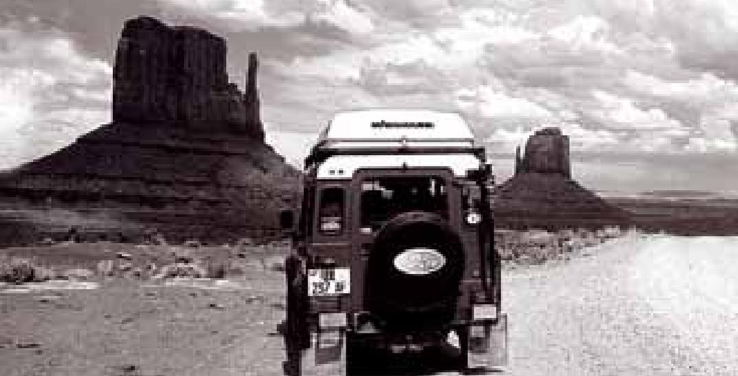
La evidente bombatura del tetto permette di mantenere all'interno dei gusci tutto l'occorrente per la notte.
