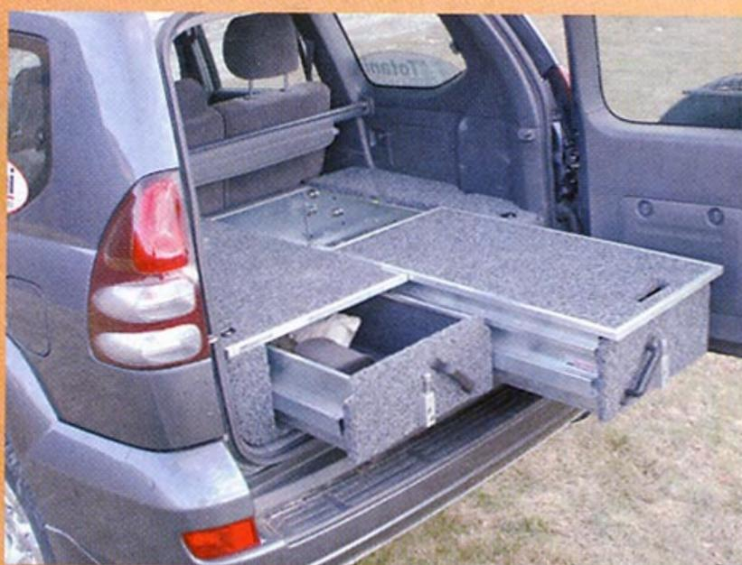
**Interni** Il vano bagagli ora è più funzionale grazie alla cassettera scorrevole Outback. Nella foto a sinistra si notano lo switch per deviare il prelievo del carburante da un serbatoio all'altro e quello dell'indicatore del livello carburante. Il tasto che consente di disinserire l'ABS è integrato nel quadretto alla sinistra del guidatore.
