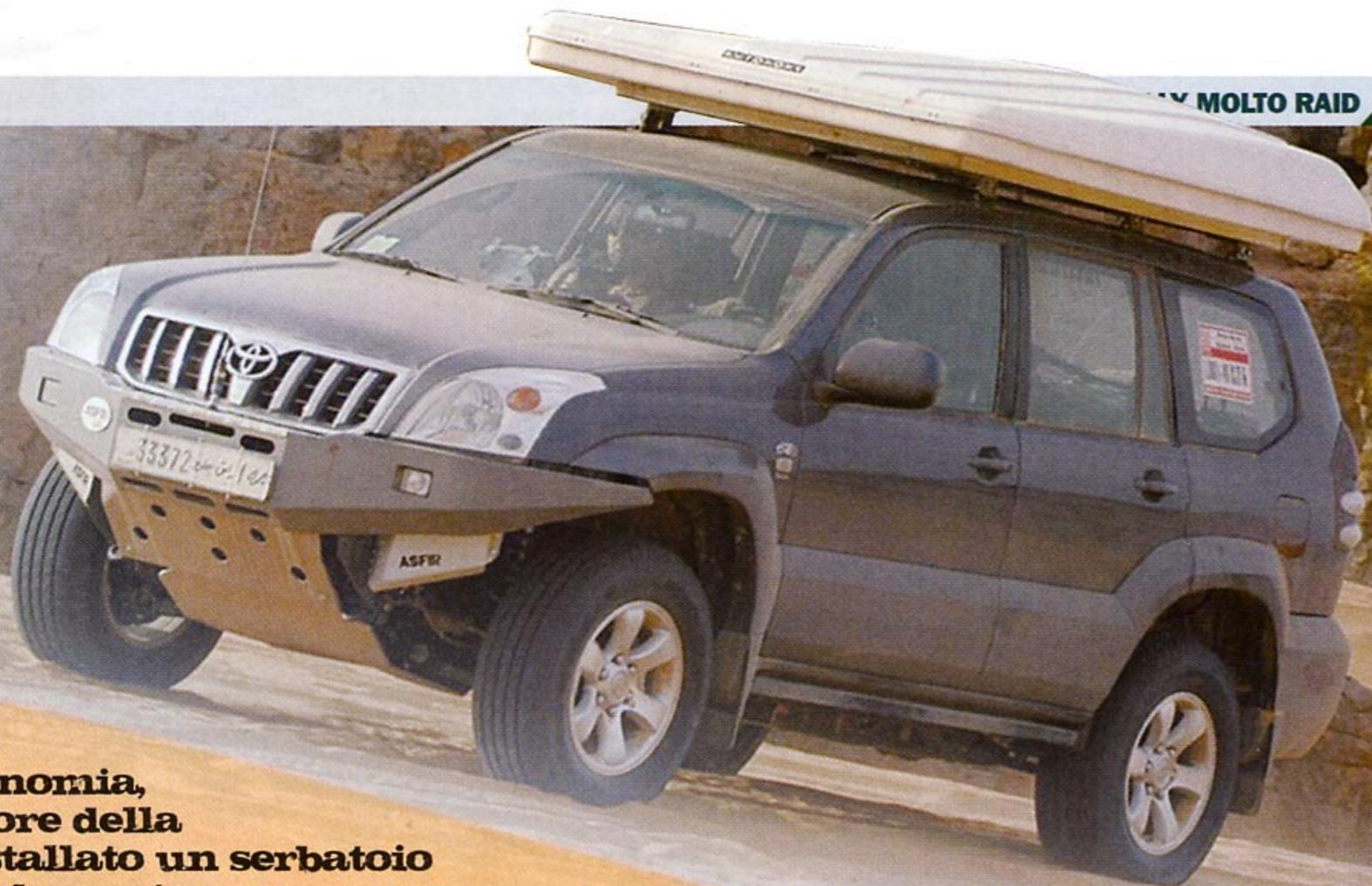
Un ulteriore step di preparazione per i viaggi può includere: verricello; snorkel; serbatoio dell'acqua con impianto di riscaldamento, pompa e rubinetti; un rialzo dell'assetto leggermente superiore (al massimo di 2-3 centimetri in più, per non stressare il differenziale e i semilassi anteriori).
