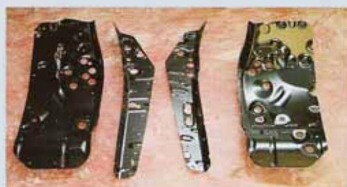
Ce kit est quasi indispensable pour qui roule sur pistes avec un KDJ à suspensions renforcées. Il est référencé chez Toyota France et comprend quatre pièces de soutien pré-formées en acier, à boulonner dans les joues d'ailes intérieures et sur leur dessus au niveau du capot, cette fois côté extérieur. Sa mise en place nécessite 16 heures de travail.
