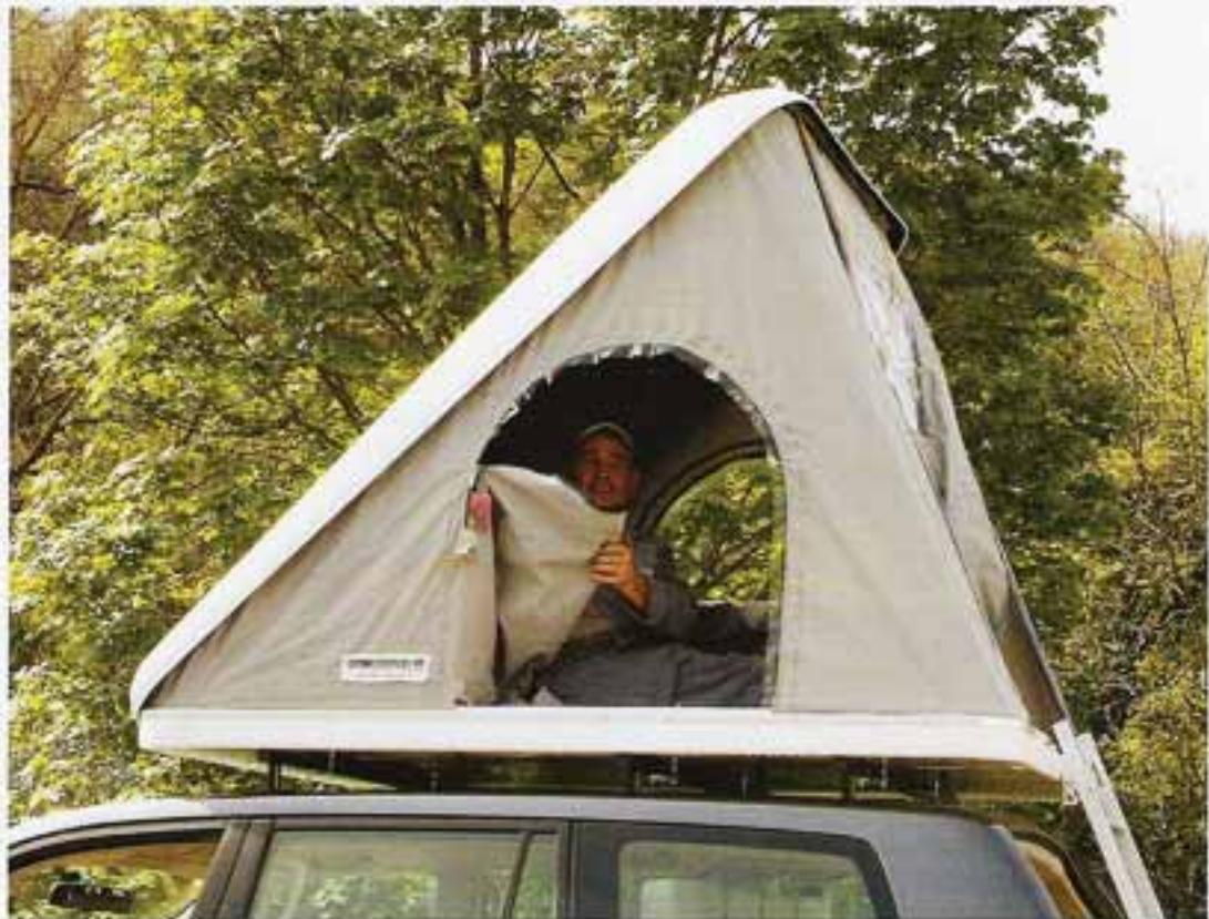
La tente retenue par le propriétaire est une Autohome Columbus "Variant Small". C'est une biplace qui pèse 43 kg et qui mesure, hors tout, 210 cm de long sur 130 de large et 30 de haut fermée (150 cm ouverte). Elle est fixée par trois barres Toyota qui reposent sur des platines dans les glissières d'origine du toit.
