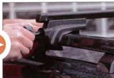
**03** La bulloneria delle barre non deve essere ossidata; se è il caso la si sostituisce. Le barre vanno montate distanziate, una in avanti e l'altra ben indietro, per rendere più stabile l'ancoraggio della tenda e ridurre la sollecitazione sugli attacchi.
