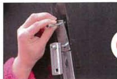
**04** Prima di issare la tenda sul tetto si controlla che le staffe di fissaggio tra la base e le barre siano a posto, che anch'esse non siano ossidate o deformate da un precedente serraggio. Poiché il loro costo è modesto, meglio averne un paio di scorta.
